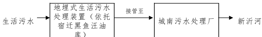
图 3.13-8 宿迁输油站生活污水处理技术路线
